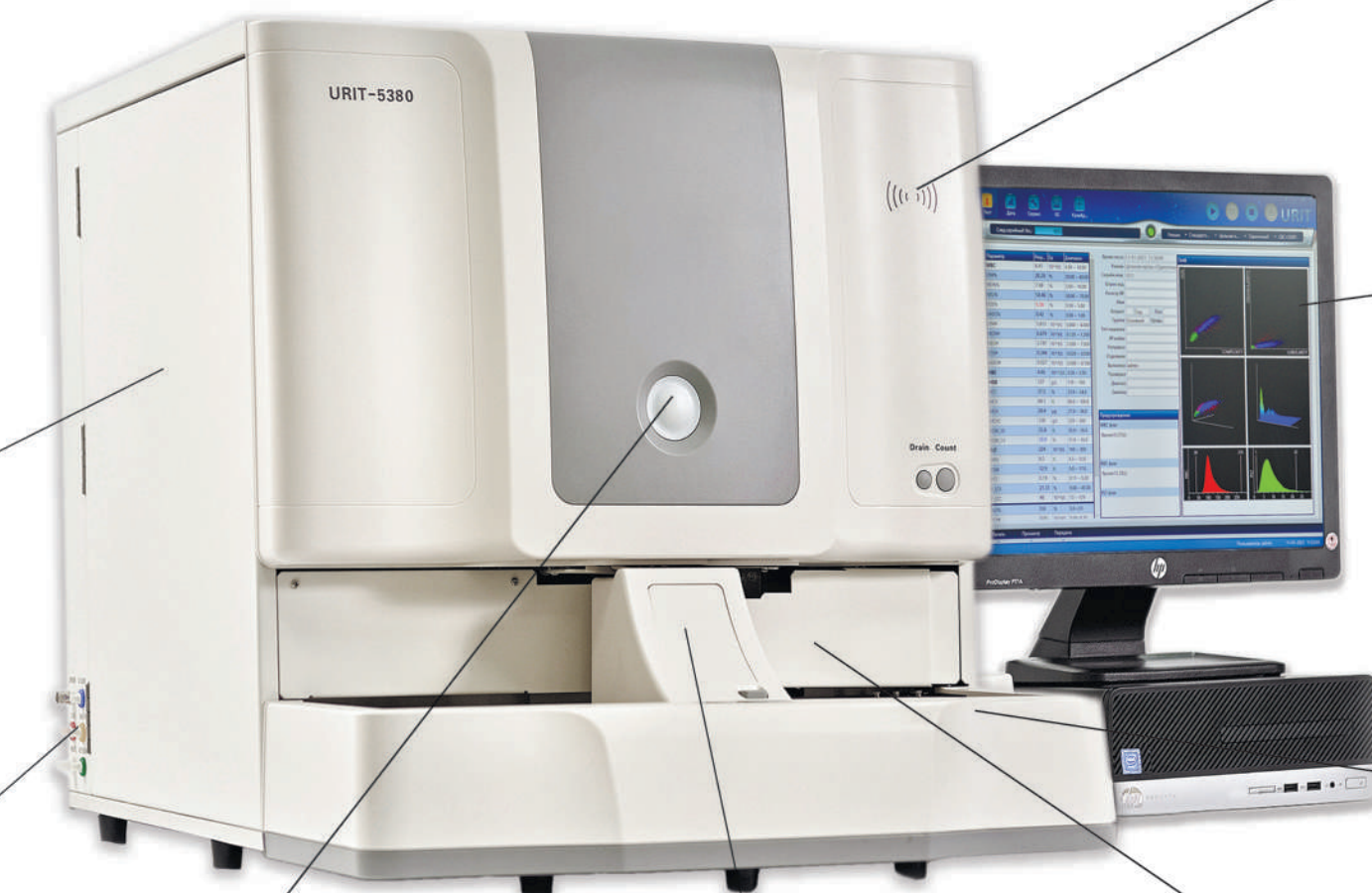
Проточная 4-х угловая лазерная цитометрия. Подсчёт WBC оптическим методом и дифференцировки по 5 популяциям
